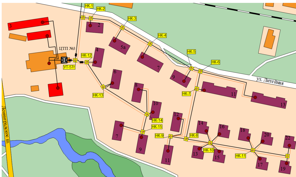
Рисунок 57 – Предполагаемое место строительства ЦТП №3 и трассировка трубопроводов в районе ул. Литейная и ул. Героя Богданова в здании котельной бани.
