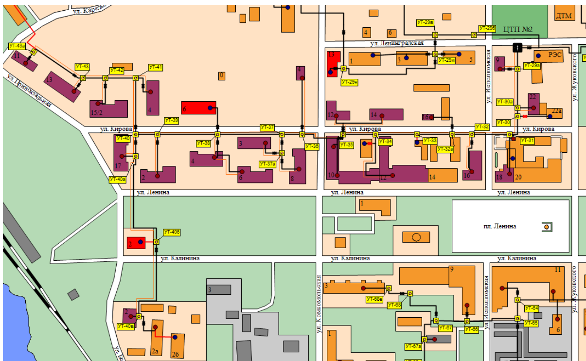
Рисунок 56 – Предполагаемое место строительства ЦТП №2 и трассировка трубопроводов в районе ул. Кирова
