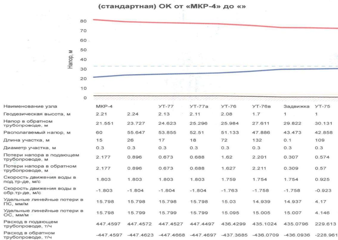
**Рисунок 10 – Пьезометрический график работы тепловых сетей котельной № 2**
