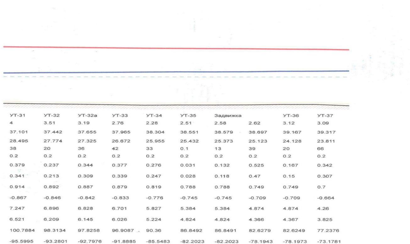
Рисунок 7 – Пьезометрический график работы тепловых сетей котельной № 1 – Продолжение (YT-31 – YT-37)
