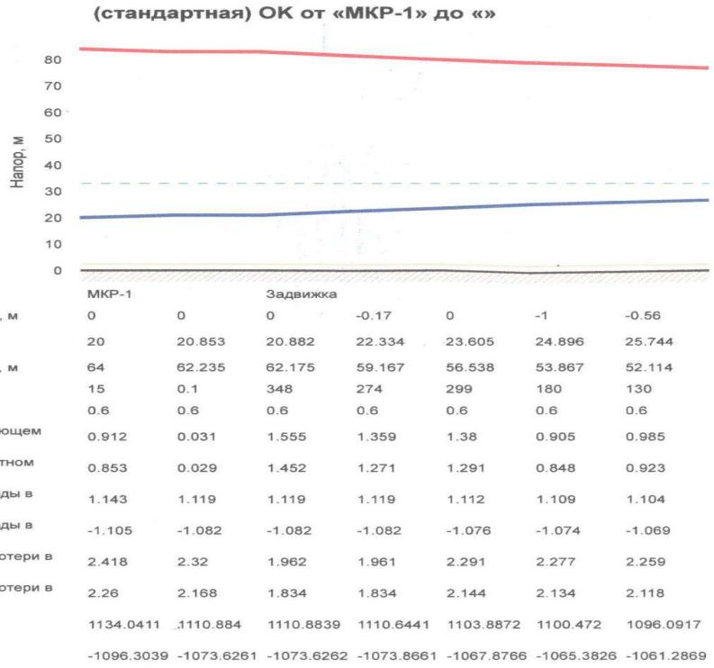
**Рисунок 2 – Пьезометрический график работы тепловых сетей котельной № 1 (начало)**
